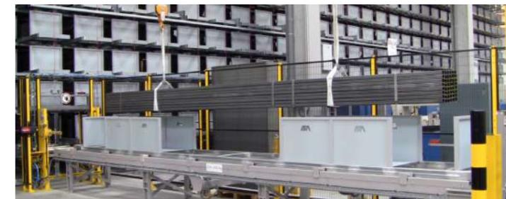
Poste de chargement sur convoyeur motorisé
